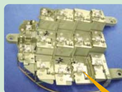
はんだを使用しない (鉛フリー)LEDの固定
