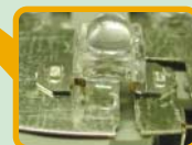
はんだを使用しない (鉛フリー)LEDの固定
