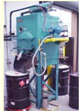
アセトン蒸留再生設備
