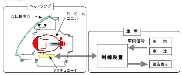
舵角信号、車速信号から旋回半径を算出し、ロービームの照射軸を左右に回転させ 最適な方向に光を照射する
