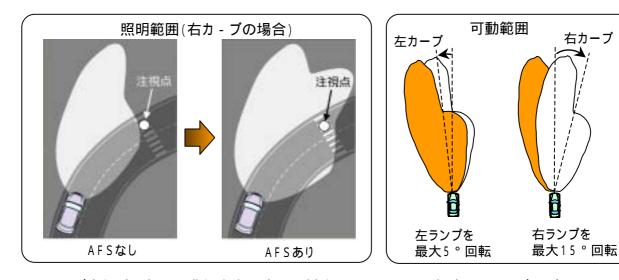
カーブ走行時、車両の進行方向に光を照射することにより、運転中のドライバーが見ているポイント(注視点)を含む広範囲な視界が確保され、人、物、動物や駐車車両等の障害物をいち早く発見し、より安全に回避行動を取ることを可能とする。
