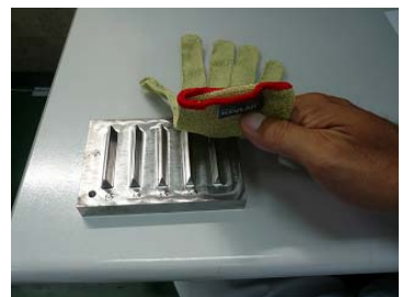
金型エッジ部の体感治具 (保護手袋の重要性確認)
