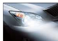
右カーブで右ランプが 右側最大15度照射
