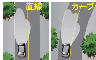
右カーブで右ランプが 右側最大15度照射
