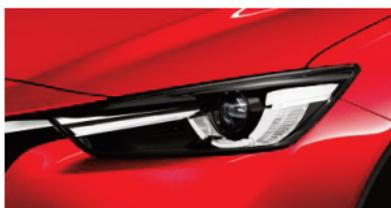
ロービーム一体 LEDアレイ式 ADBヘッドランプ搭載 マツダ「CX-3」
