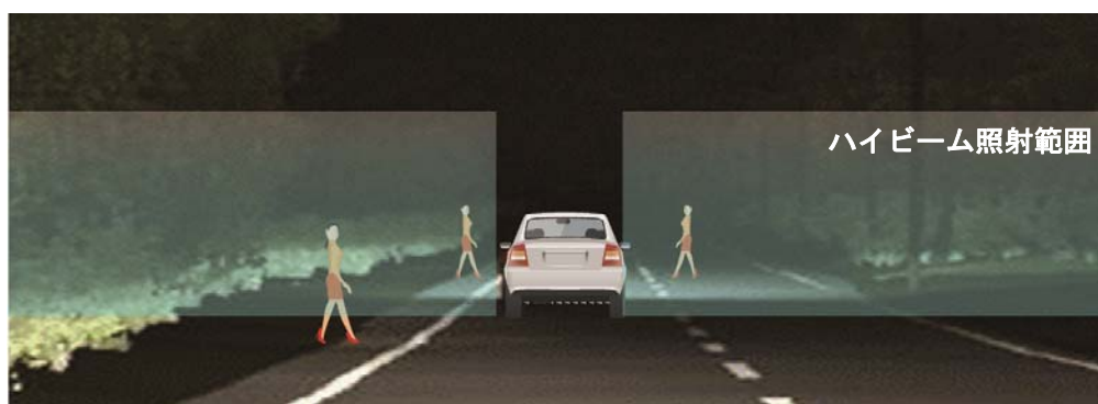
前走車の際まで照射することで、より遠方の歩行者を認識可能
