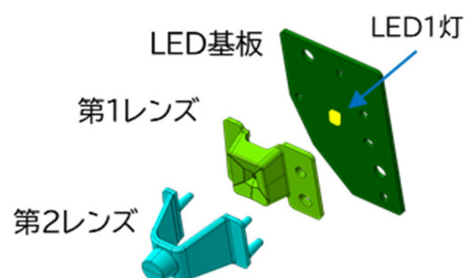
SRP ユニットは1つのLEDと2枚のレンズ という極めてシンプルな構成で小型化
