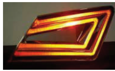
LEDソケットを使用したテール&ストップランプ
